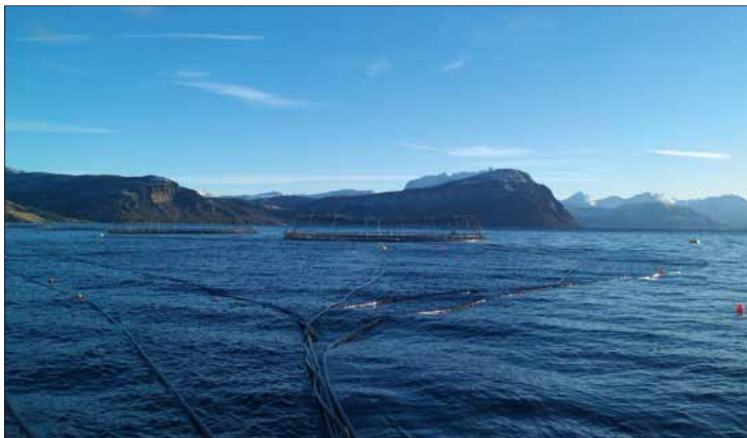
Figur 1.9-1. Sentralfôringssystem med fôringsrør som går fra en sentral fôrflåte til kommersielle oppdrettsmerder. (Foto: C. Noble)
