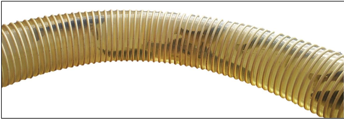
Figur 1.2-3. Fiskens sin atferd under pumping kan overvåkes gjennom den gjennomsiktige slangen. Foto: Å. M. Espmark.
