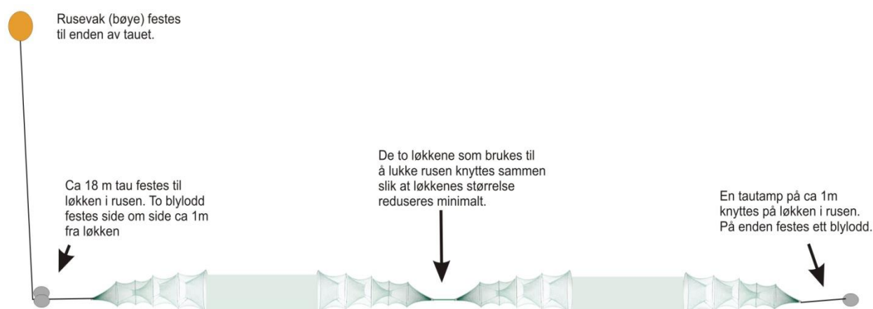
Figur 13. Montering av et ruseoppsett, som i rapporten betegnes som en ruse.
