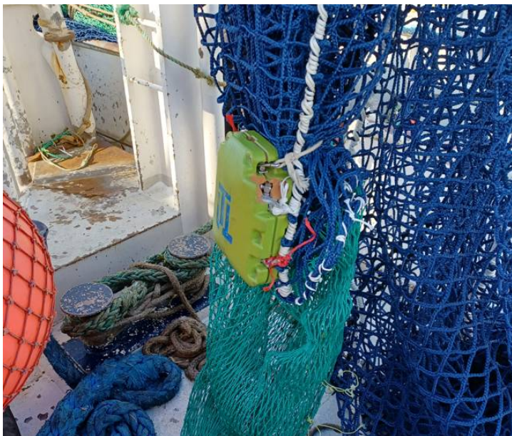
Figur 2. Utløser montert bakerst på sekk (blå kvadratmaske), ved overgang sekk-opsamlingspose (grønn diamantmaske).
