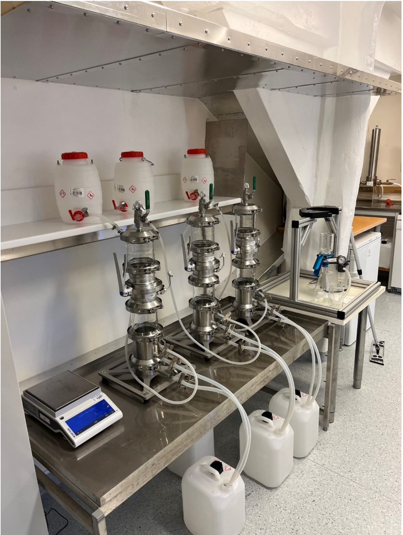
Figur 6: Bauta-stasjonen i HI sitt sedimentseparasjonslab.
