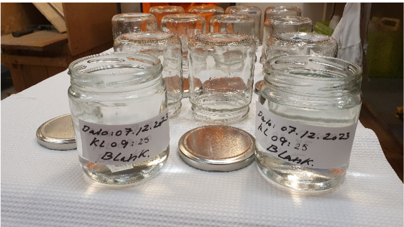
Figur 5: Blankprøve tatt sammen med uttak av en sedimentprøve.
