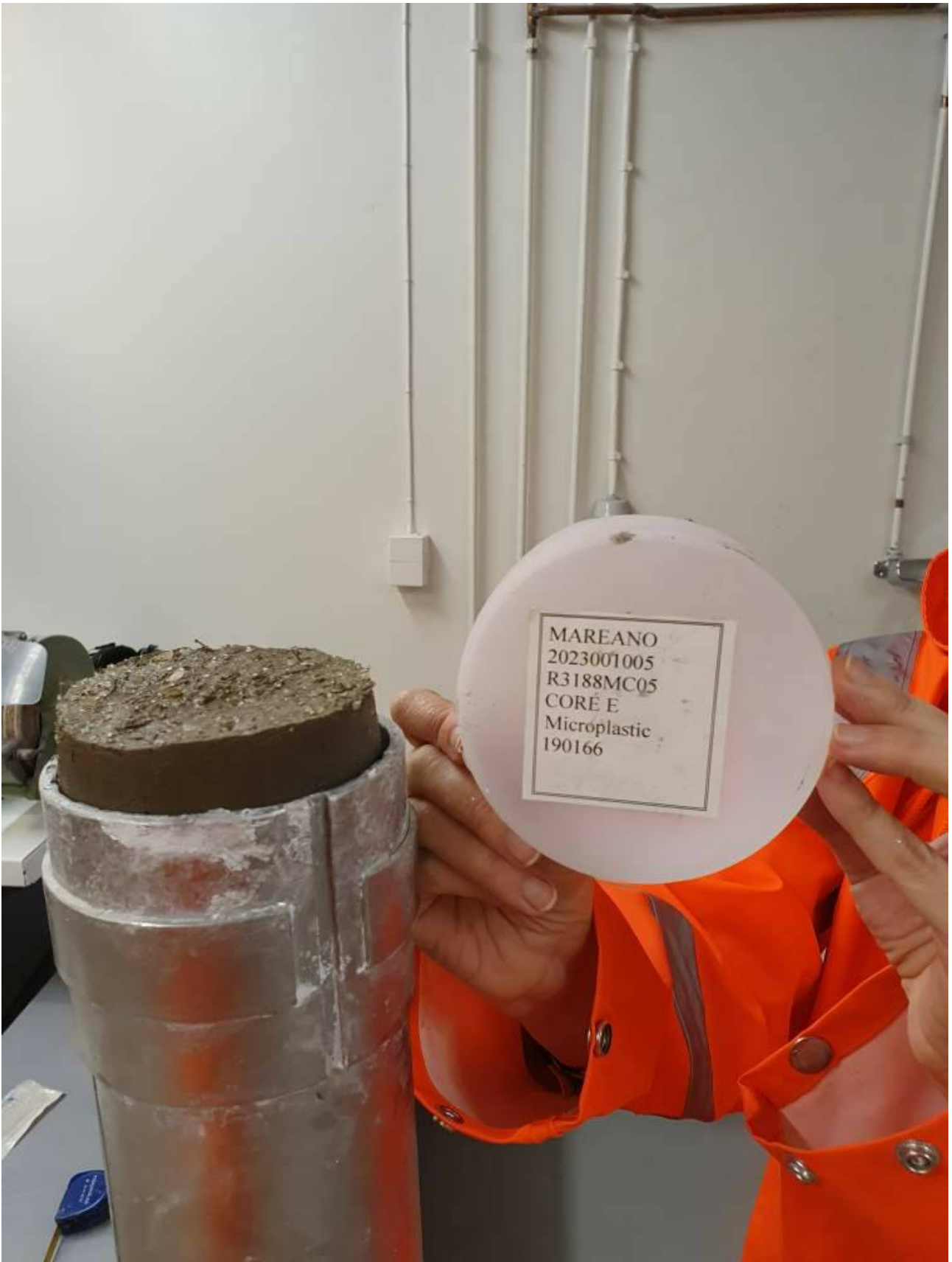
Figur 3: Utskyvning av sedimentprøve fra stålrør.
