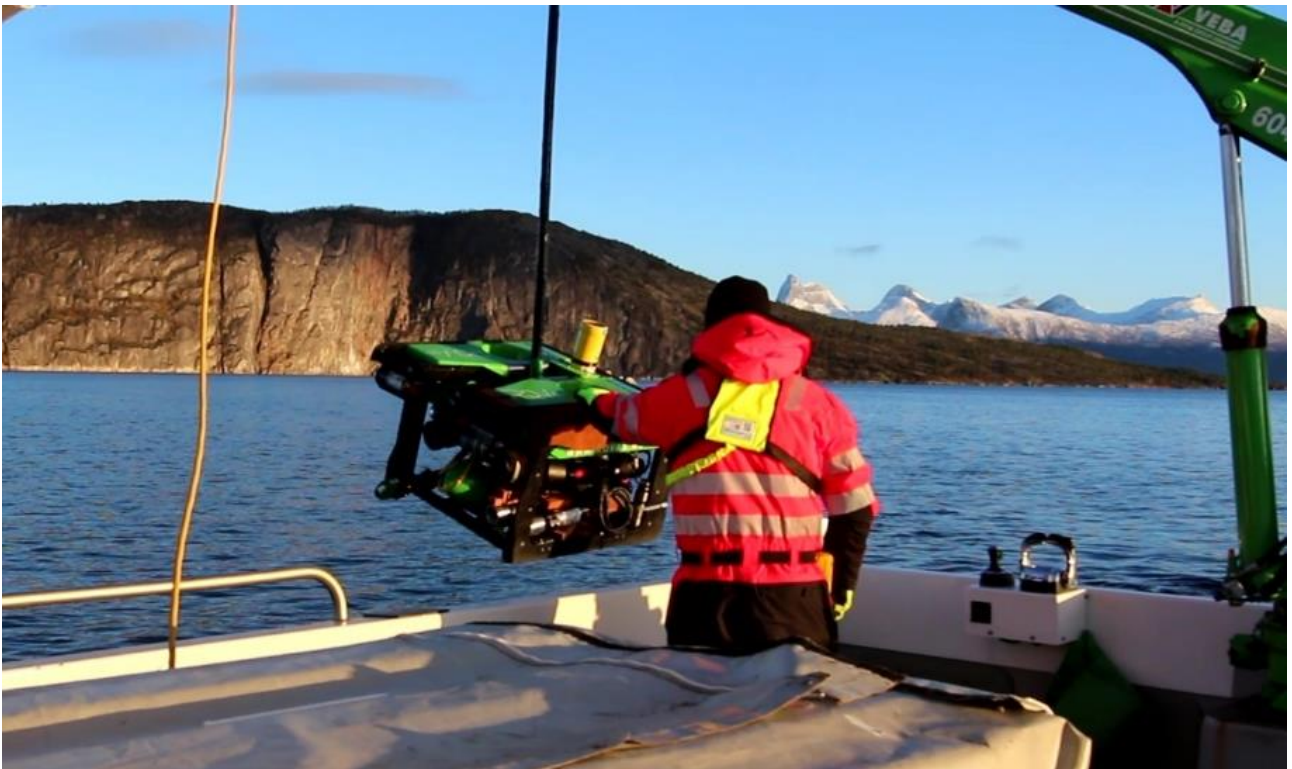
Figur 2. Argus Rover 73 ROV fra ROV AS brukt under nylige kartleggingstokt i 2023/24 i Tysfjorden. Bilde: HI
