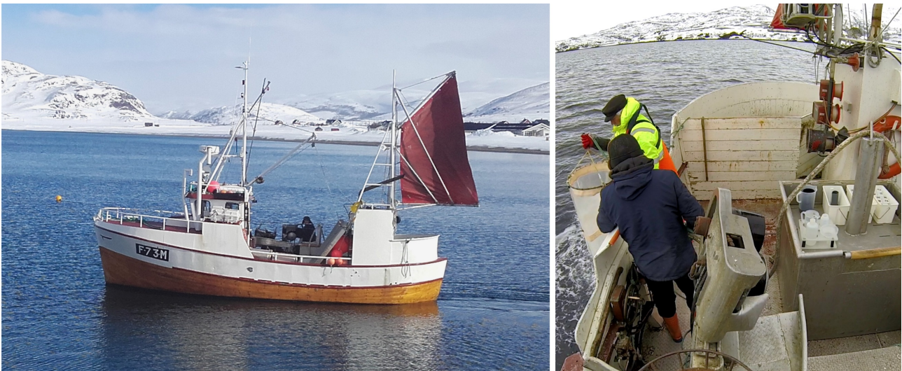
Figur 1. Båten som ble benyttet på de tre første toktene (t.v.) var en Finnvik 35' sjark med Petterspill og Rapphydema etterhaler som ble brukt til å dra egghåven. Spyling av håv (t.h.).
