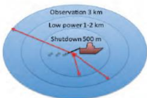
Figur 2.6.1. Eksempel på sikkerhetssone for total stopp av lydutsending (500 m), redusert nivå (1–2 km) og registrering av observasjoner (3 km). Figur fra Erbe et al. 2013.
