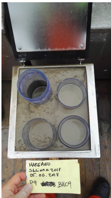
Figur 2.5. Boxcorer sett ovenfra med sedimentprøve fra lokalitet P09. Fire 106 millimeter rør er satt ned i boxcoreren. Foto: MAREANO-tokt juni 2018.
