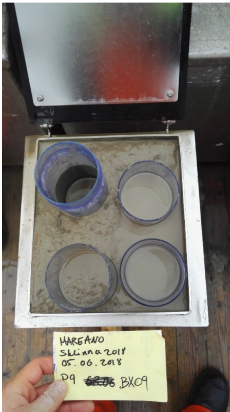
Figur 2.5. Boxcorer sett ovenfra med sedimentprøve fra lokalitet P09. Fire 106 millimeter rør er satt ned i boxcoreren. Foto: MAREANO-tokt juni 2018.
