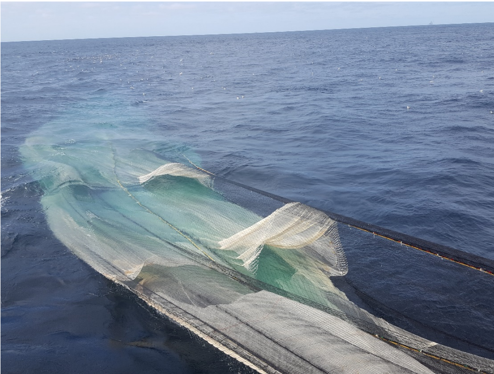
Figur 1b: Trål med «bleier» - finmaskede «tunneler» inne i trålen, festet i forkant, løse i akterkant.
