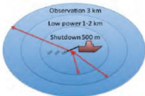
Figur 1. Eksempel på sikkerhetssone for total stopp av lydutsending (500 m), redusert nivå (1–2 km) og registrering av observasjoner (3 km). Figur fra Erbe et al. 2013.
