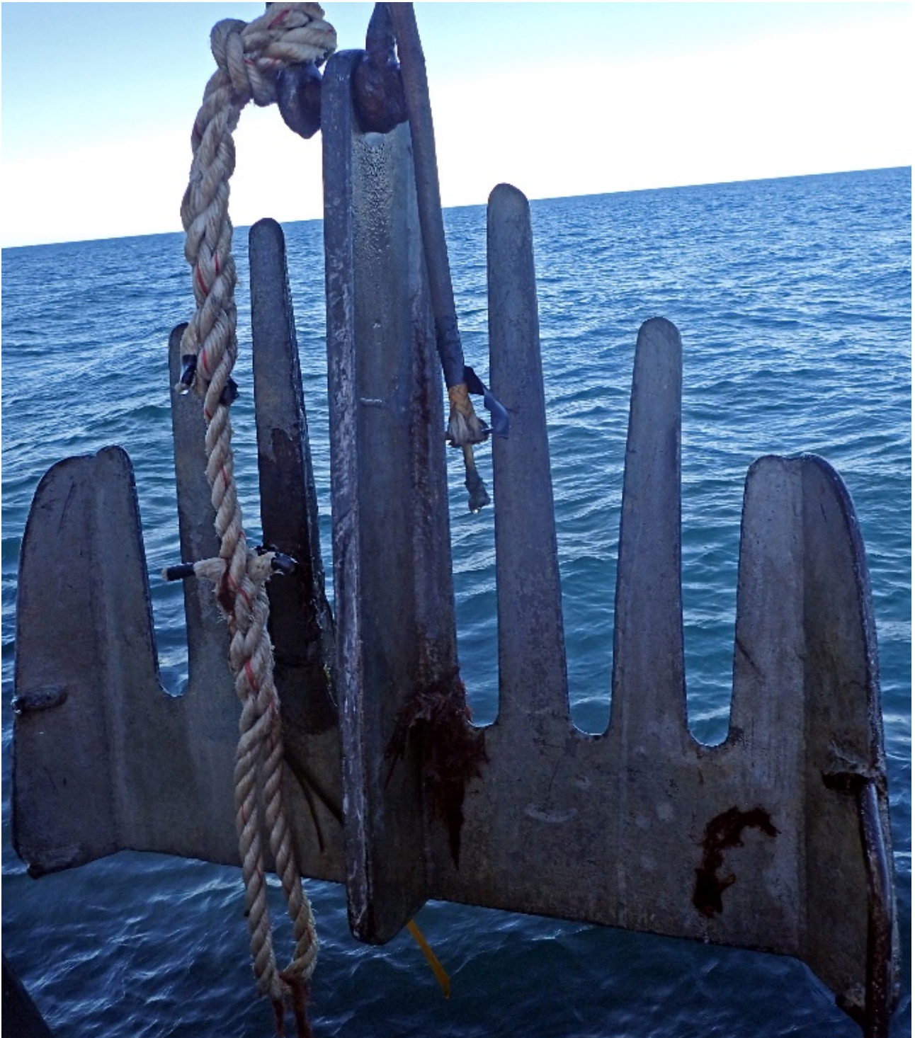
Figur 6. Tareskrape i stål (ca 60 cm bred), benyttet til innsamling av stortareplanter.
