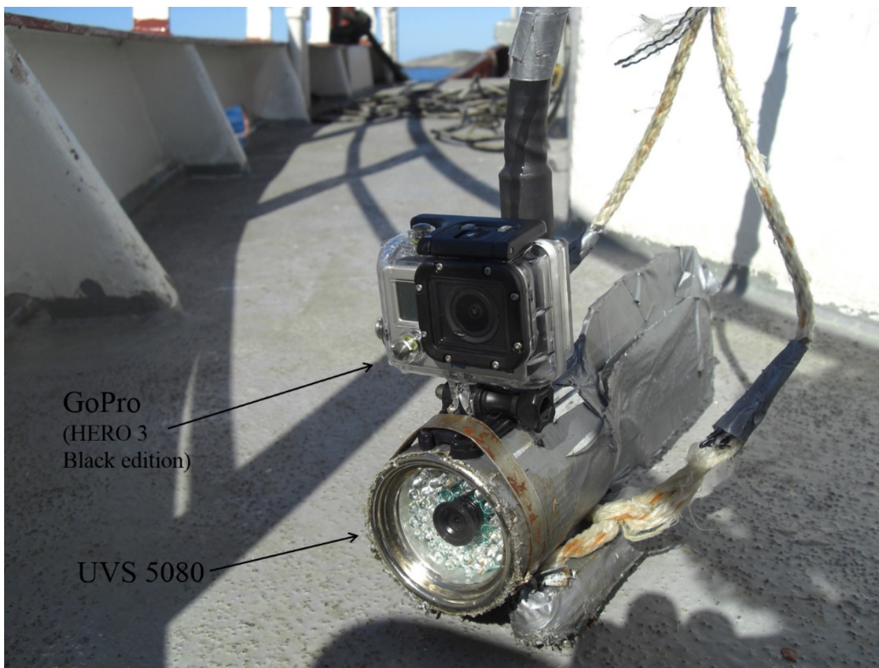
Figur 3. Undervannskamerasystemer benyttet til videoundersøkelser i Nordland.
