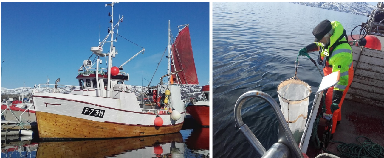
Figur 1. Båten som ble benyttet på de tre første toktene (t.v.) var en Finnvik 35' sjark med Petterspill og Rapphydema etterhaler som ble brukt til å dra egghåven. Senking av håv (t.h.).
