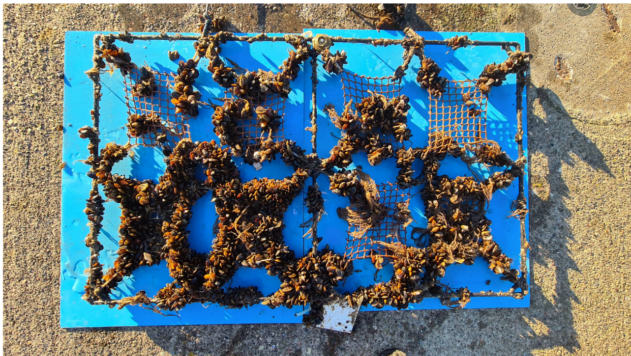
Blåskjell som vokser på notprøver med eller uten kobberimpregnering. Foto: Rune Antonsen.
