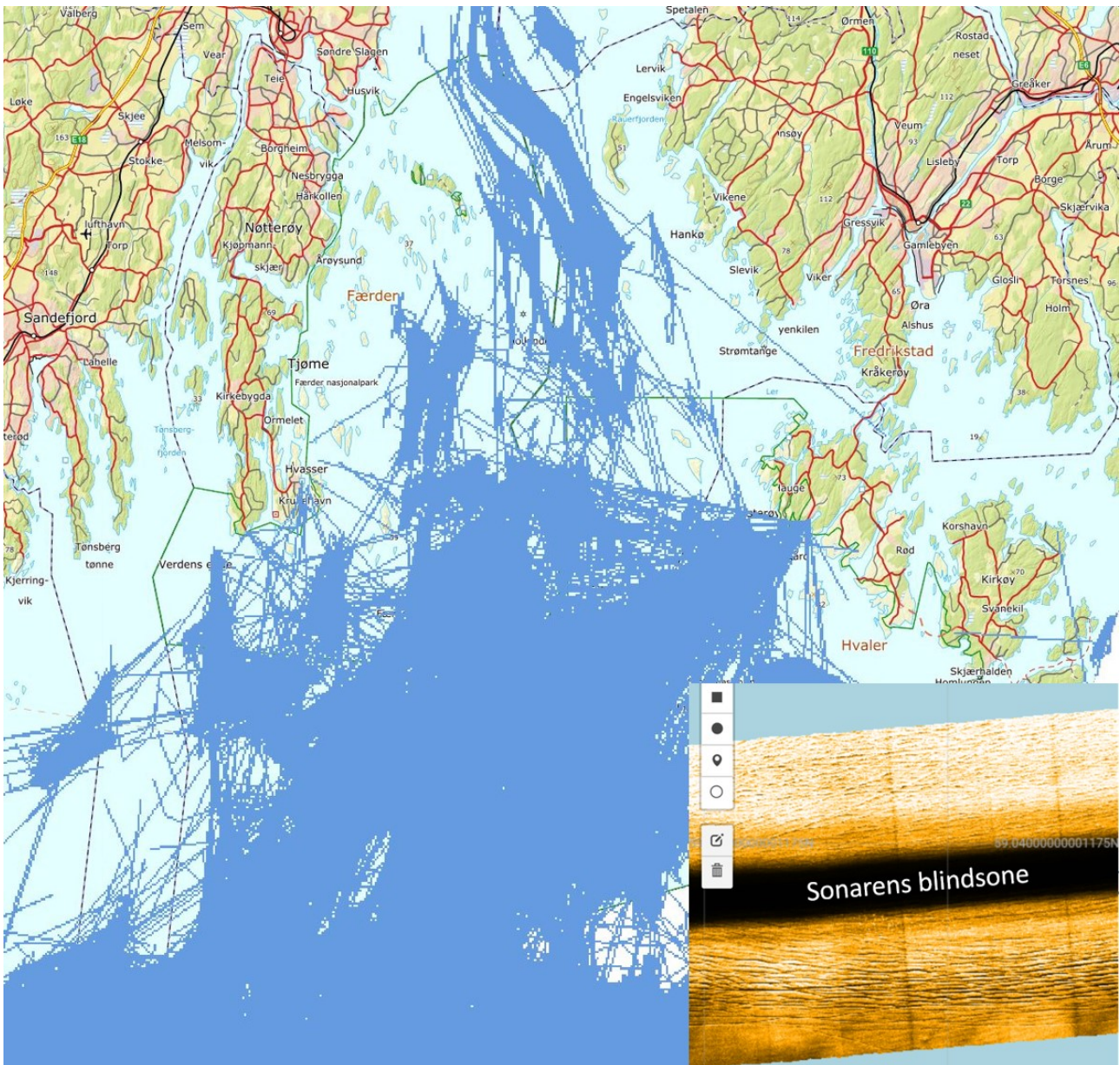
Figur 3.2.2 VMS-data («slepestrek») for fartøy som fisker med bunntrål (fartøy over 15 m lengde) i ytre Oslofjord i perioden 2011–2019 (kilde: Fiskeridirektoratet). Nede til høyre: sonarbilde av trålspor på havbunnen i ytre Oslofjord tatt med Kongsberg maritimes autonome undervannsfarkost Hugin under tokt i regi av søsterprosjektet «Frisk Oslofjord» (kilde: Kongsberg maritime). «Glatting» av VMS-data vil være nødvendig for å benytte disse til vurderinger av grad av belastning fra denne flåtegruppen i perioden.
