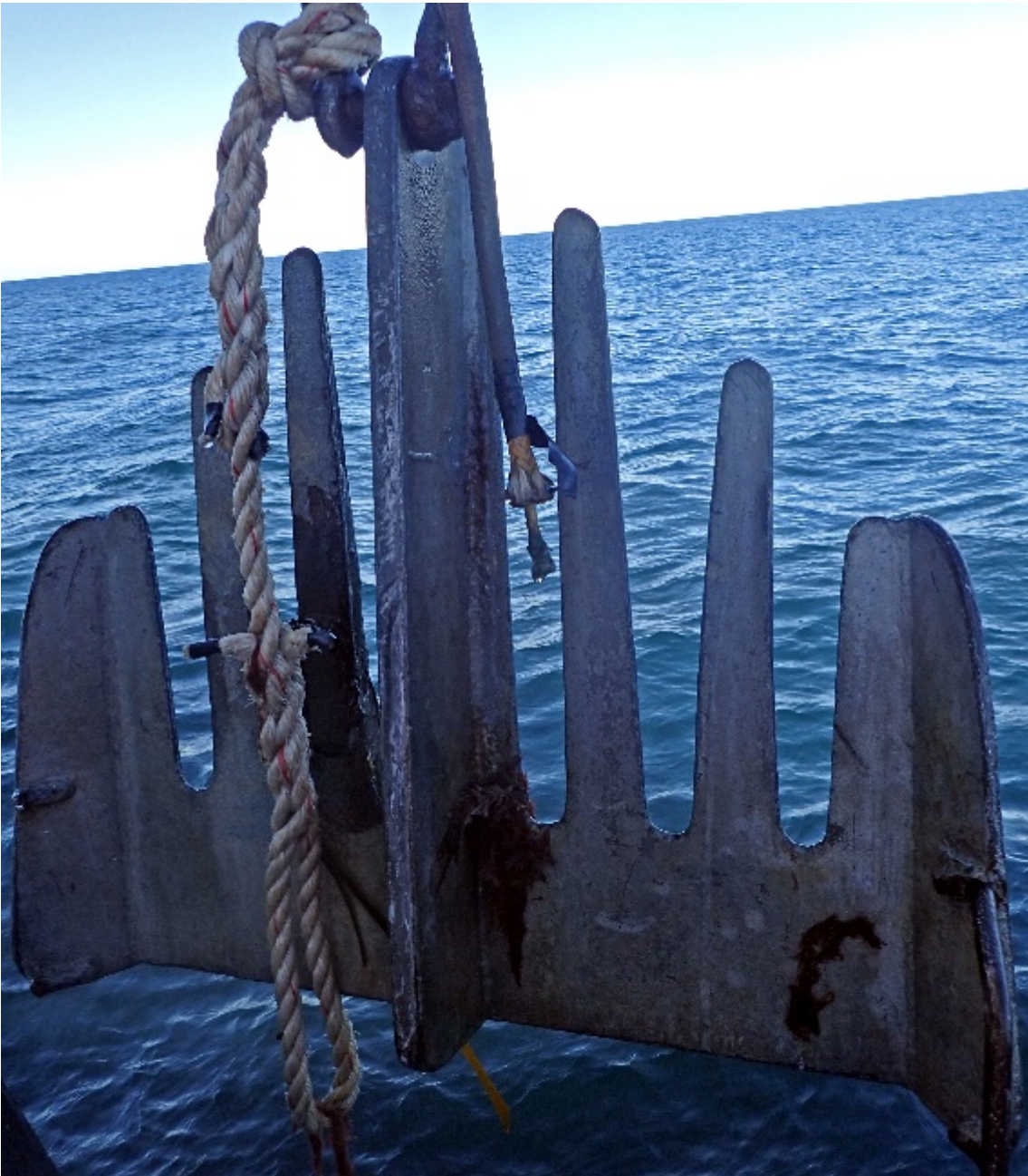
Figur 4. Tareskraper i stål (ca 60 cm bred), benyttet til innsamling av stortareplanter.
