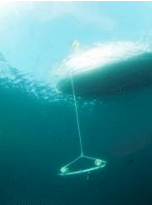
Figur 5. I Kelpfish-prosjektet ble ny teknologi tatt i bruk for å samle vitenskapelige data i tareskog. Rigger for stereovideo ble utviklet for dette prosjektet. (Foto: Jonas Thormar / Havforskningsinstituttet)
