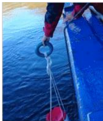
Montering av lykt i lokk (over til venstre). Festing av fløyt ring over lysfellen (over til høyre).
