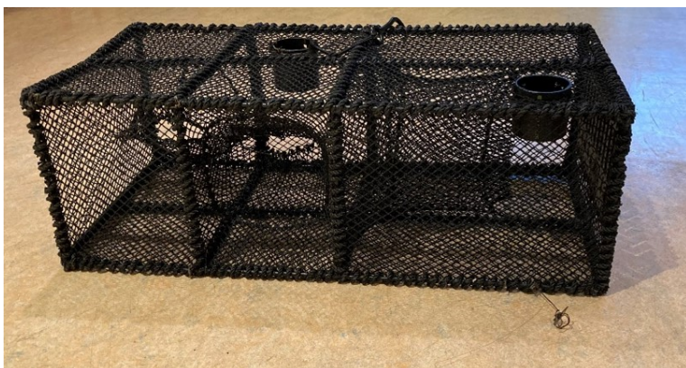
Figur 7.1. Leppefiskeiteine utstyrt med fluktåpninger (rør) i taket på begge kammer. Rørene har en indre diameter på 68 mm og stikker 53 mm ned i teina. Inngangene på leppefisk teina er 60 mm i diameter. Fluktåpningene skal kunne slippe ut all fisk som har tatt seg inn, men hindre krabber i å ta seg ut. Denne type fluktåpning vil bli testet ut i fiskeforsøk juni 2022. Lignende fluktåpninger har vært prøvd ut i teinefiske etter krabber i USA. https://www.greencrab.org/blog/2020/8/22/talking-traps
