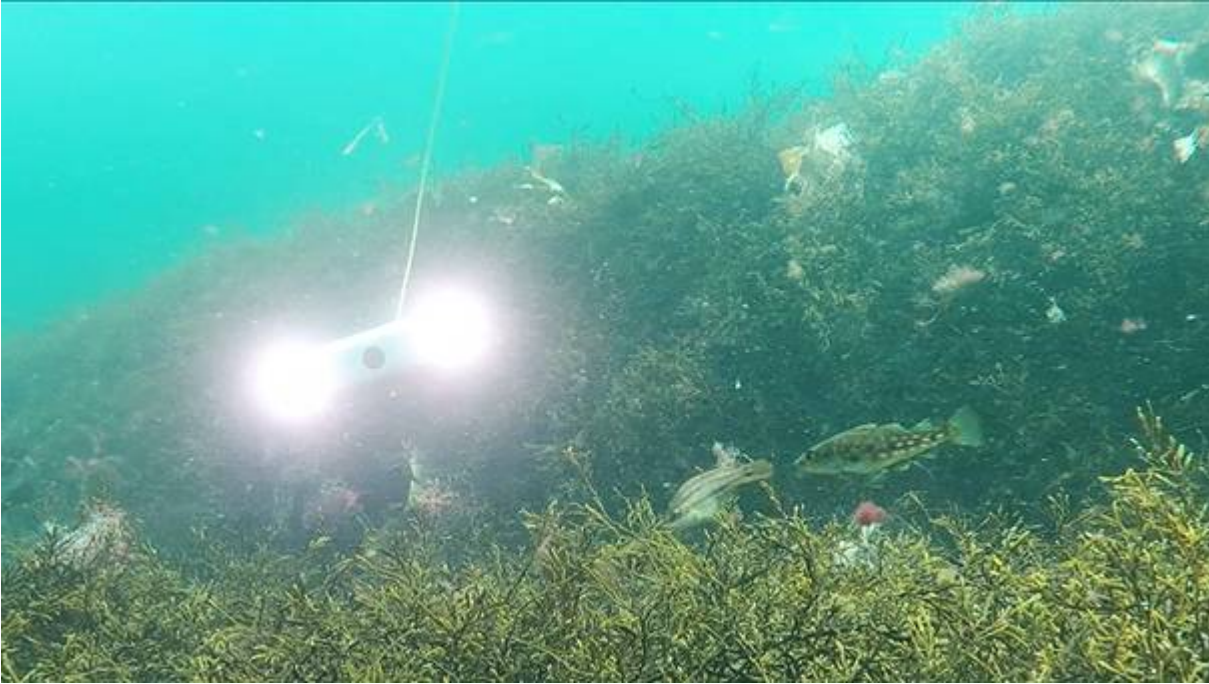
Bilde 5: En undervannsdrone som beveger seg over bunnen. Ledning opp bak er tilknyttet følgebåten. Bildet er tatt fra en RUV.
