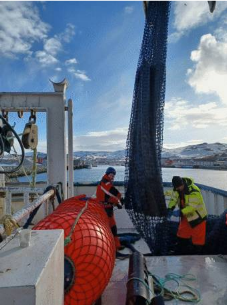
Figur 16 Svart presenning i kvadratmaskeforlengelse.
