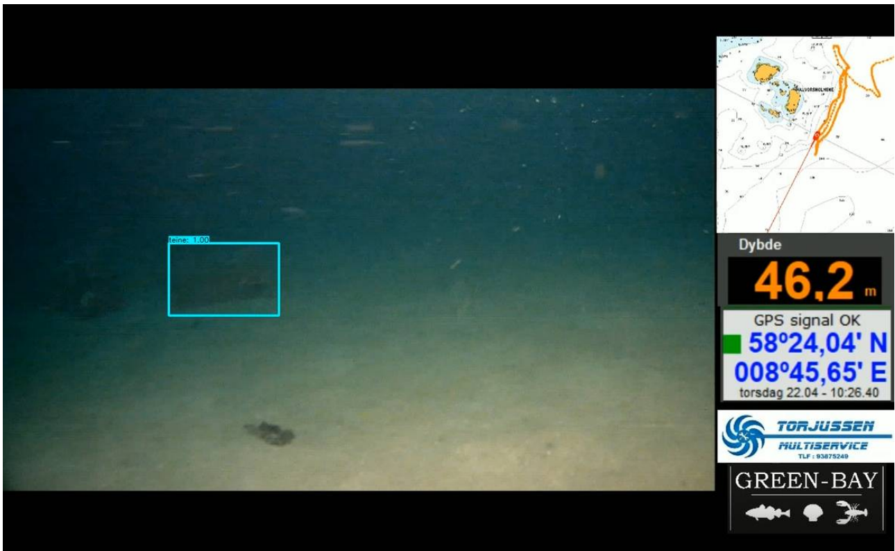
Figur 15: Deteksjon av teime med maskinsyn på video fra slepekamera.
