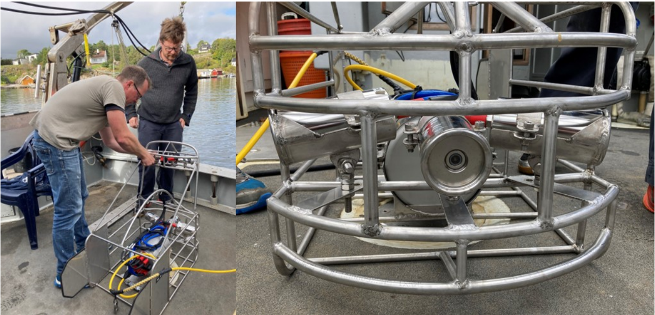
Figur 14: Slepekamerarigg med tre kameraer.
