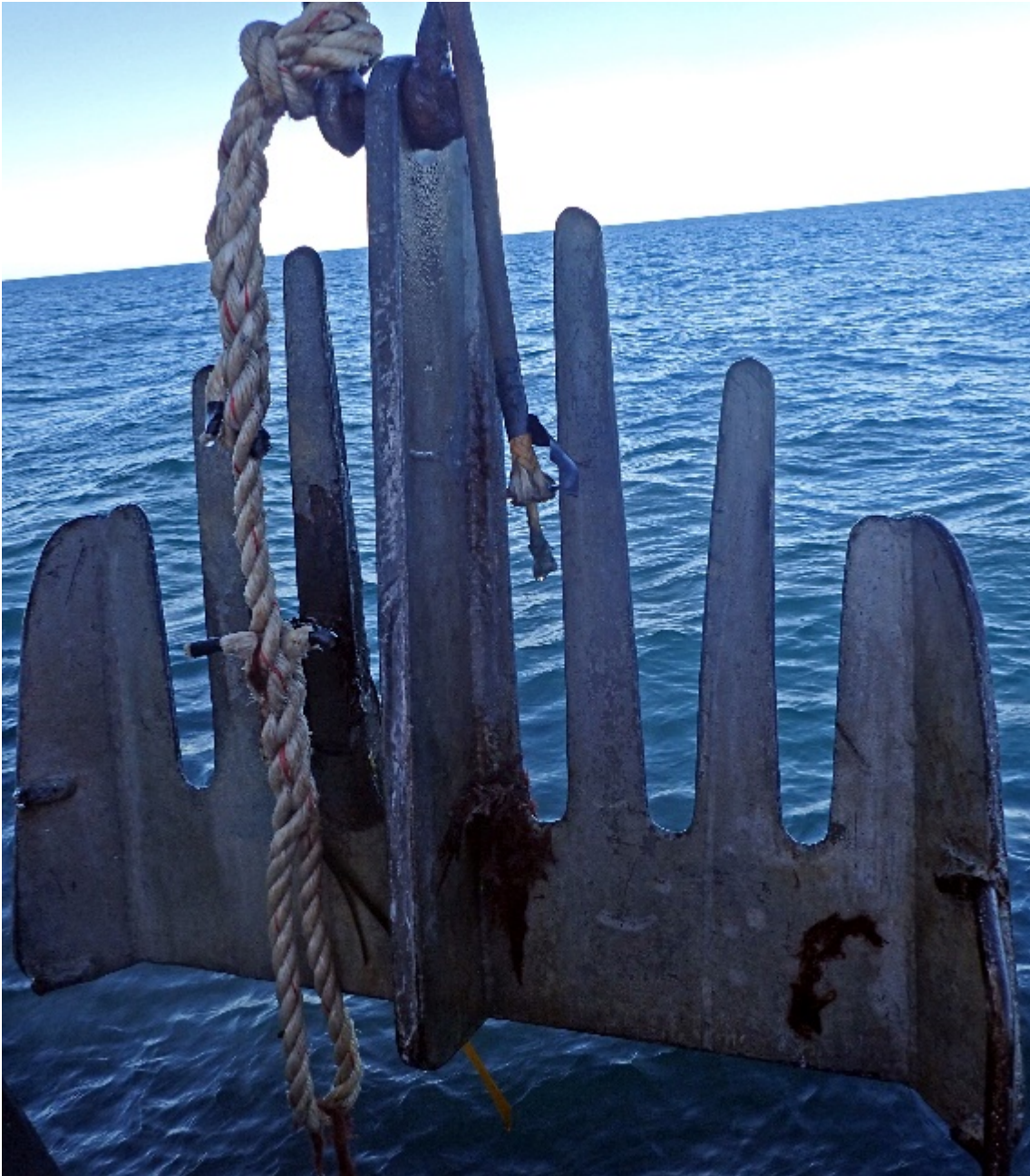
Figur 5. Tareskrape i stål (ca 60 cm bred), benyttet til innsamling av stortareplanter.
