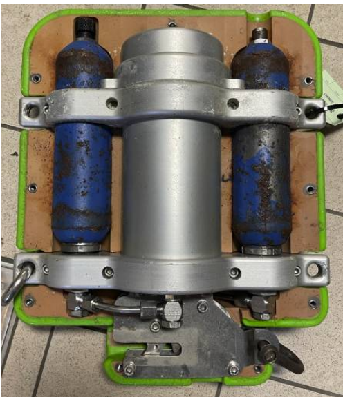
Bilde 5. Dekselet på den mekaniske utløseren måtte fjernes for å få inn sjakkel (nederst til høyre på bildet).
