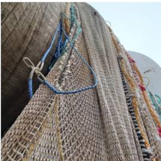
Bilde 19. Selve spaltene (topp og sider) og tauene rundt har holdt seg (bilde til venstre, men ved enden på V-ene på spissene slites hull. Det samme gjelder for alle de tre spaltene.
