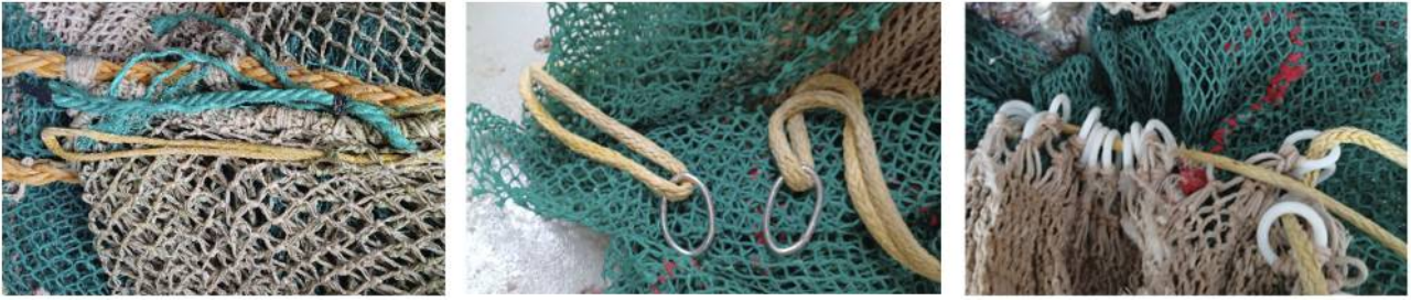
Bilde 20. Stroppene som festes til leistau er begge intakt (venstre). Ringene er deformert (midten). P-ledd mellom stropper og ringer er slitt av (antatt bruddstyrke p-ledd 1000 – 1500 kg). Ringene som rundstroppen går gjennom er intakt (høyre).
