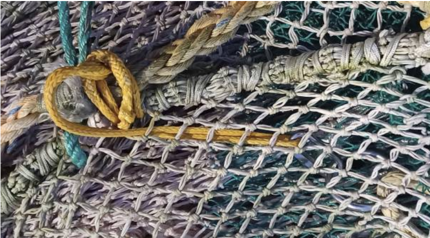
Bilde 4. Dyneema tau festet med p-ledd til stålring. Rundstroppen på fiskelåsen går gjennom stålringen.
