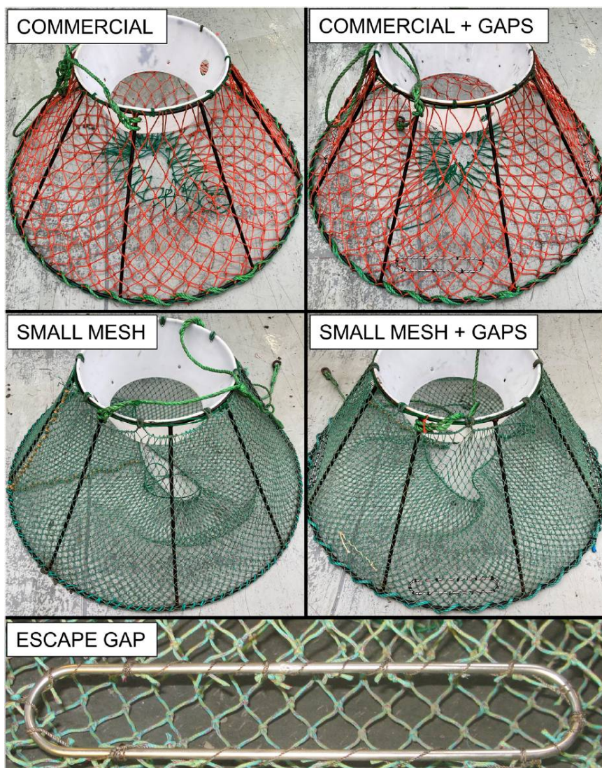
Figur 3.12 Øvre og midterste figur: De fire teinene som ble sammenlignet. Nederste figur: Fluktåpningen som ble montert nede på fire av sidefeltene på teinene. Fluktåpningene var 30 cm vid og 4 cm høy og tilpasset minstemål som var gjeldende frem til 2021 (100 mm skallbredde).
