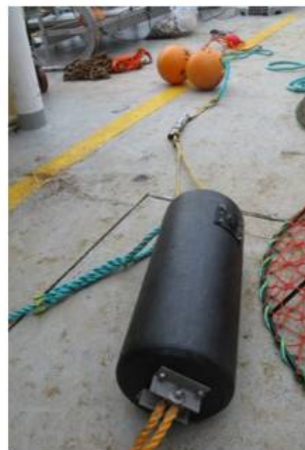
Figur 5.1 Venstre: Prinsippskisse undervannsbøye med akustisk utløser. Høyre: Bilde av IceCatcher systemet.
