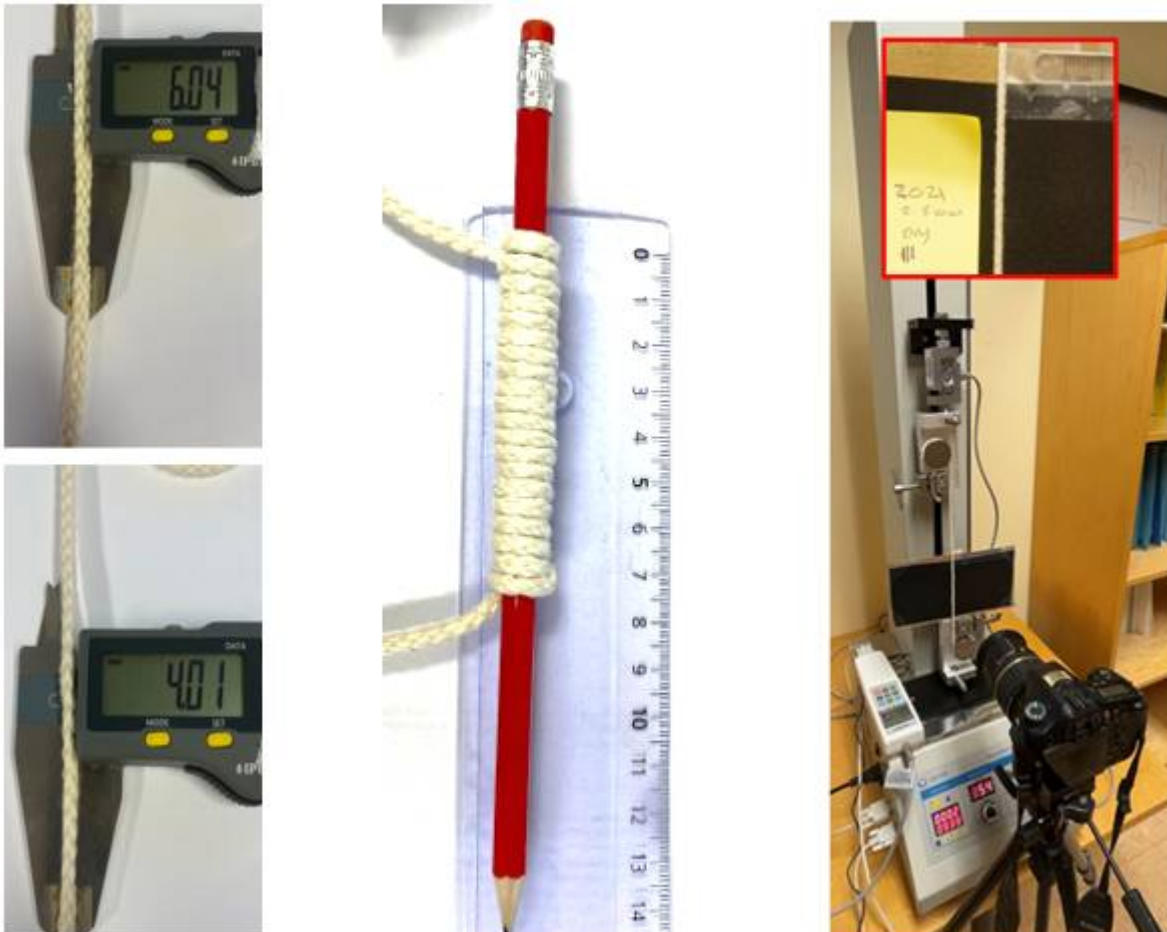
Figur 4.2 . Ulike metoder for måling av tråddykkelse (diameter). Skyvelæremetoden er enkel, men har åpenbart en del usikkerhet knyttet til hvor stramt tråden er strukket og hvor hardt den er presset mot målegapet på skyvelæret. Med skyvelære er det også viktig å måle fra ulike sider om tråden ikke er rund. Eksempelet viser måling av tråd nr. 6 (5 mm), en tråd med tilnærmet rektangulært tverrsnitt. Blyantmetoden med 20 surringer er også en enkel metode, men som for skyvelære vil det uten ytterligere standardisering være variasjon i hvor stramt tråden strekkes under surringen og hvor tett omgangene legges på blyanten. Optisk måling under standardisert strekk anses som den mest objektive metoden, men også den mest tid- og utstyrskrevene.
