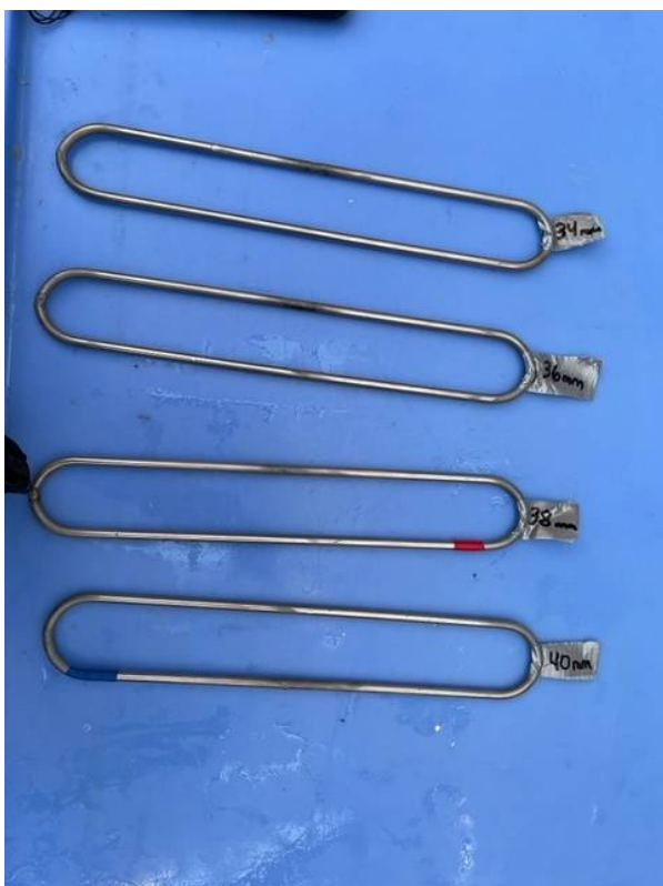
Figur 3.7 Fluktåpninger med 34-40 mm spaltehøyde.
