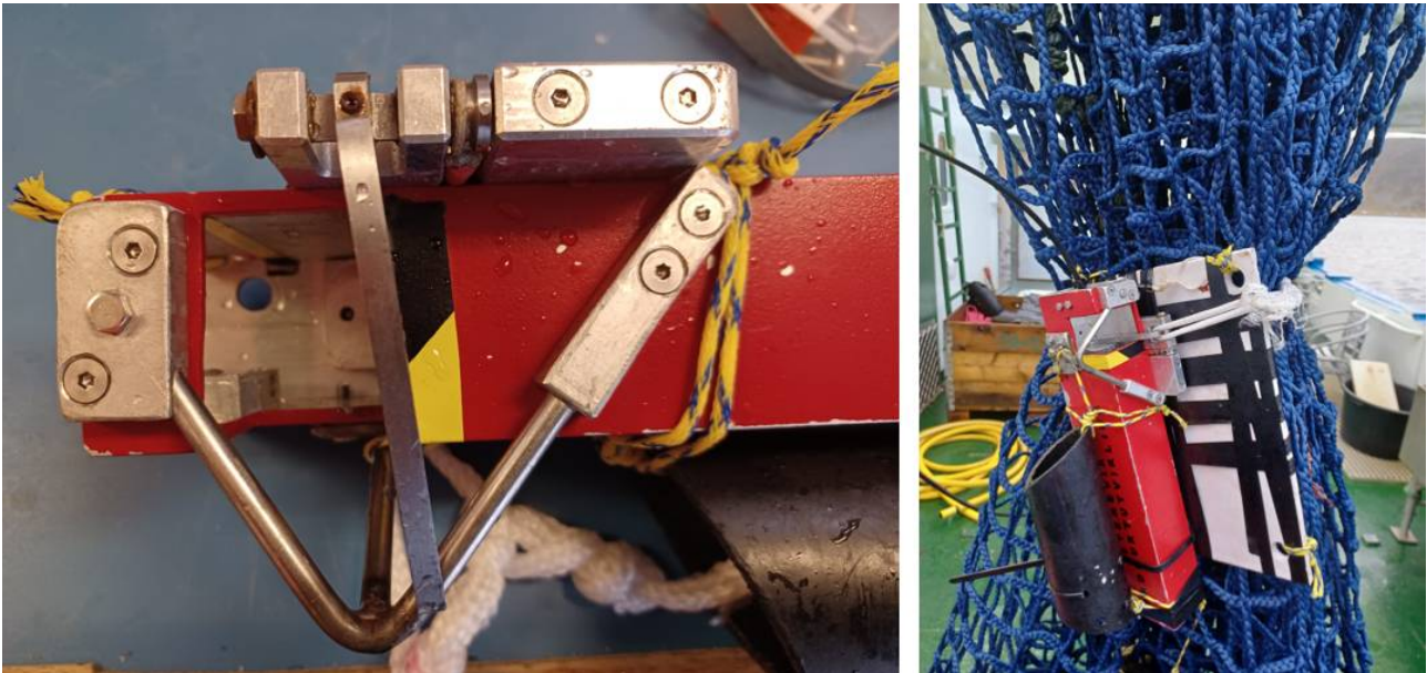
Figur 16. Utløseren etter første hal på tokt 4 i 2022. Til venstre ser vi den skjeve utløserarmen. På bildet til høyre er utløseren montert på en plastplate for å få et bedre moment på utløserarmen fra tauet (tråden) som knytes rundt sekken.
