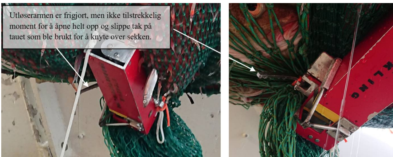
Figur 15. Fra tokt i 2020. Utløserarmen ble frigjort, men åpnet ikke overknyttingen på sekken.
