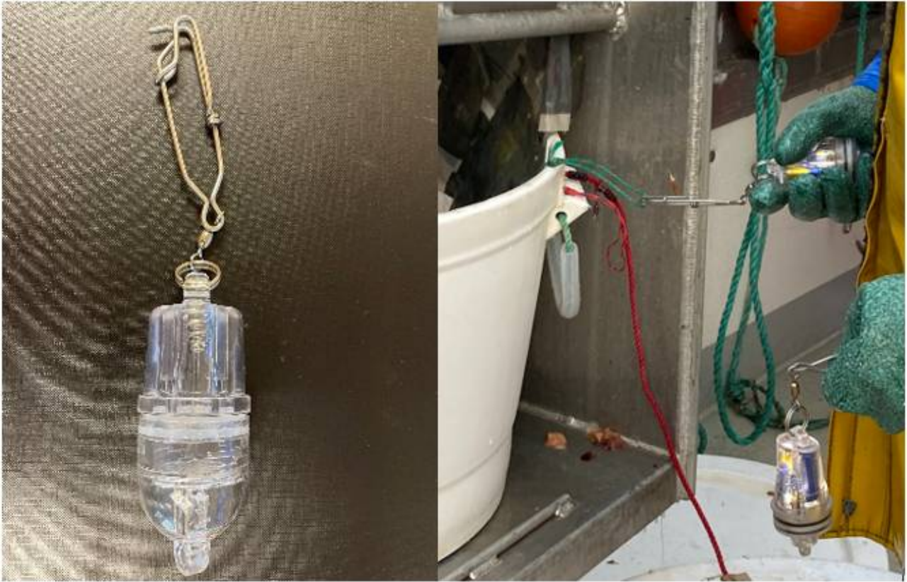
Figur 1 Fiskelys og montering av disse på «steinbånd» under setting.
