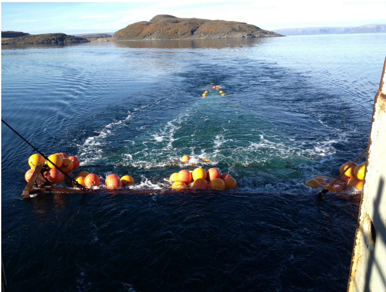
Figur 6. Agassiz-trål med fløyt og sekk.
