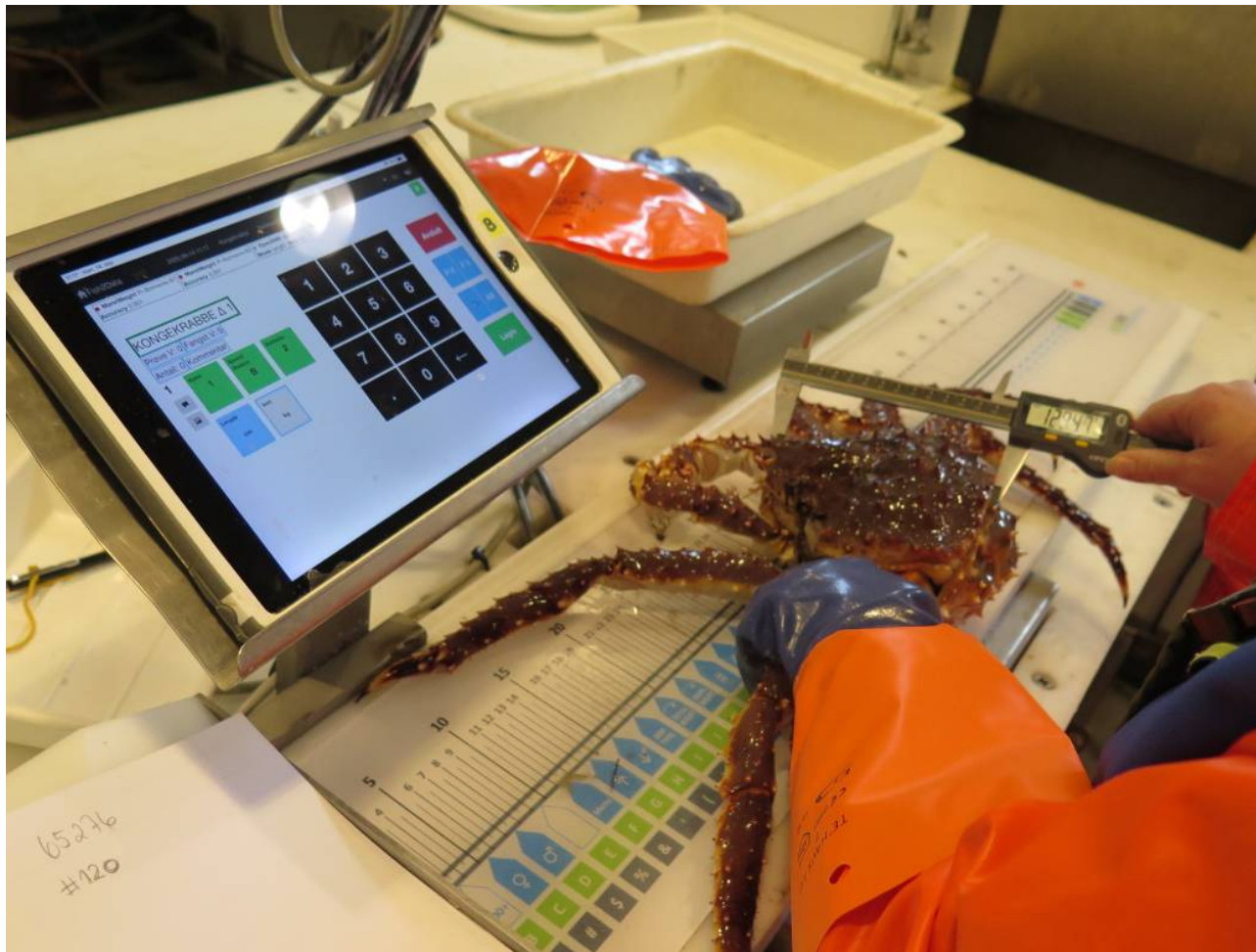
Figur 7. Registrering av data ved hjelp av trådløst skyvelære og iPad (Fish2Data).
