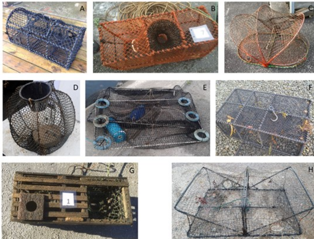
Figur 32: Eksempler på de ulike teinetyper funnet gjennom prosjektet «tiltak mot spøkelsesfiske». Fra øverst til venstre: A) skotteteine, B) krepseteine, C) klappteine, rund, D) måloyteine, E) fisketeine, F) leppfiskeiteine, G) treiteine og H) klappteine, firkantet. Bildene er tatt av frivillige dykkere og figuren er hentet fra (Thorbjørnsen et al., 2023).
