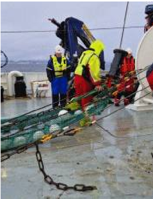
Figur 16. Innkorting av kjettinggearet på Campelen 1800-trålen med 1 m på hver side.
