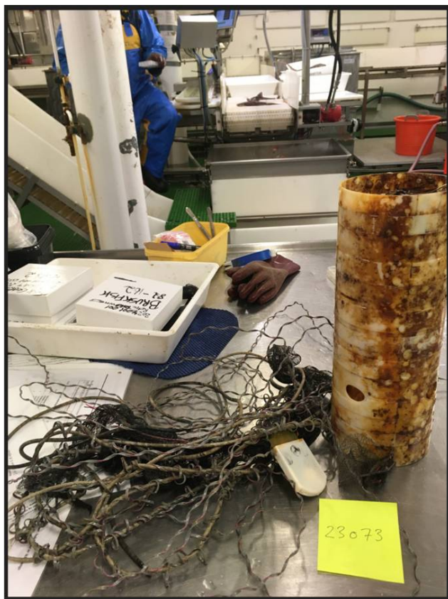
Figur 7.2: «Droptank» (venstre) fra tysk fly fra andre verdenskrig. Den hang under mindre enmotors jagerfly og inneholdt ekstra drivstoff, ifølge museet på Herdla. Når den var tom, ble den «droppet». Rester fra sannsynligvis en ubåtdetektor (høyre).
