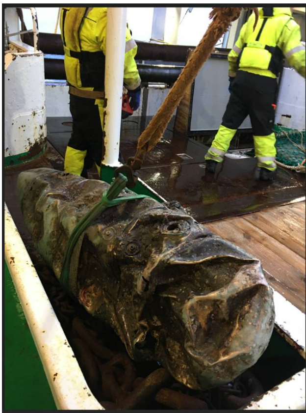
Figur 7.2: «Droptank» (venstre) fra tysk fly fra andre verdenskrig. Den hang under mindre enmotors jagerfly og inneholdt ekstra drivstoff, ifølge museet på Herdla. Når den var tom, ble den «droppet». Rester fra sannsynligvis en ubåtdetektor (høyre).
